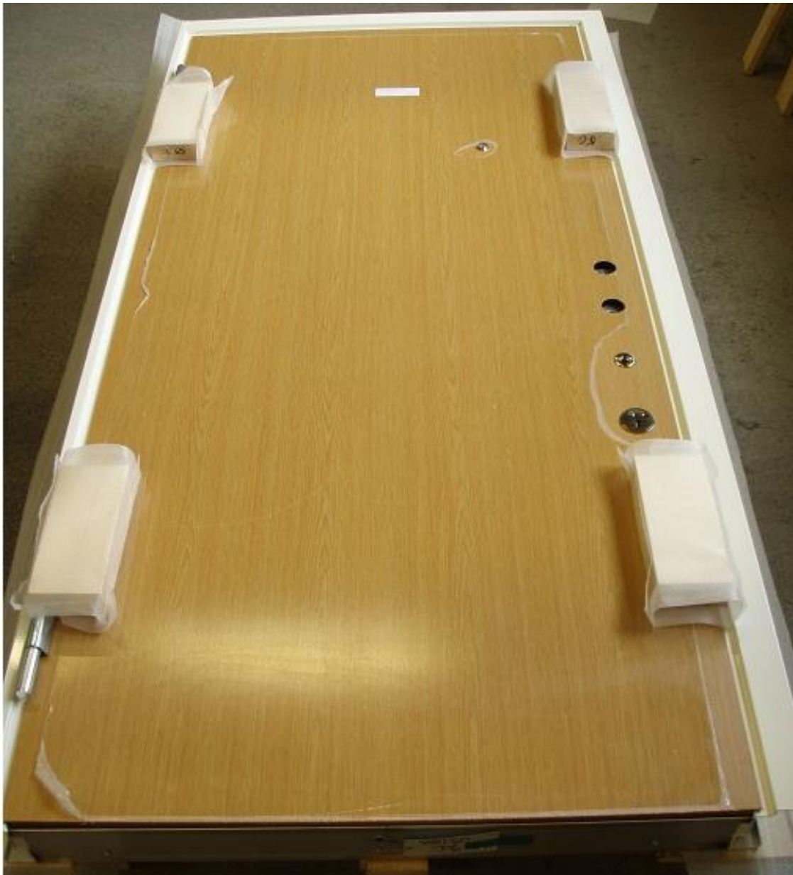
Figur 6.1 Visar de nya distanserna som läggs på plats på monteringsavdelningen.
