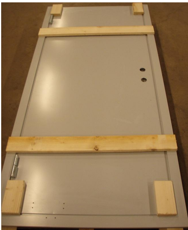
Figur 4.3 Visar hur distanserna ligger mellan dörrarna i den oförbättrade processen.
