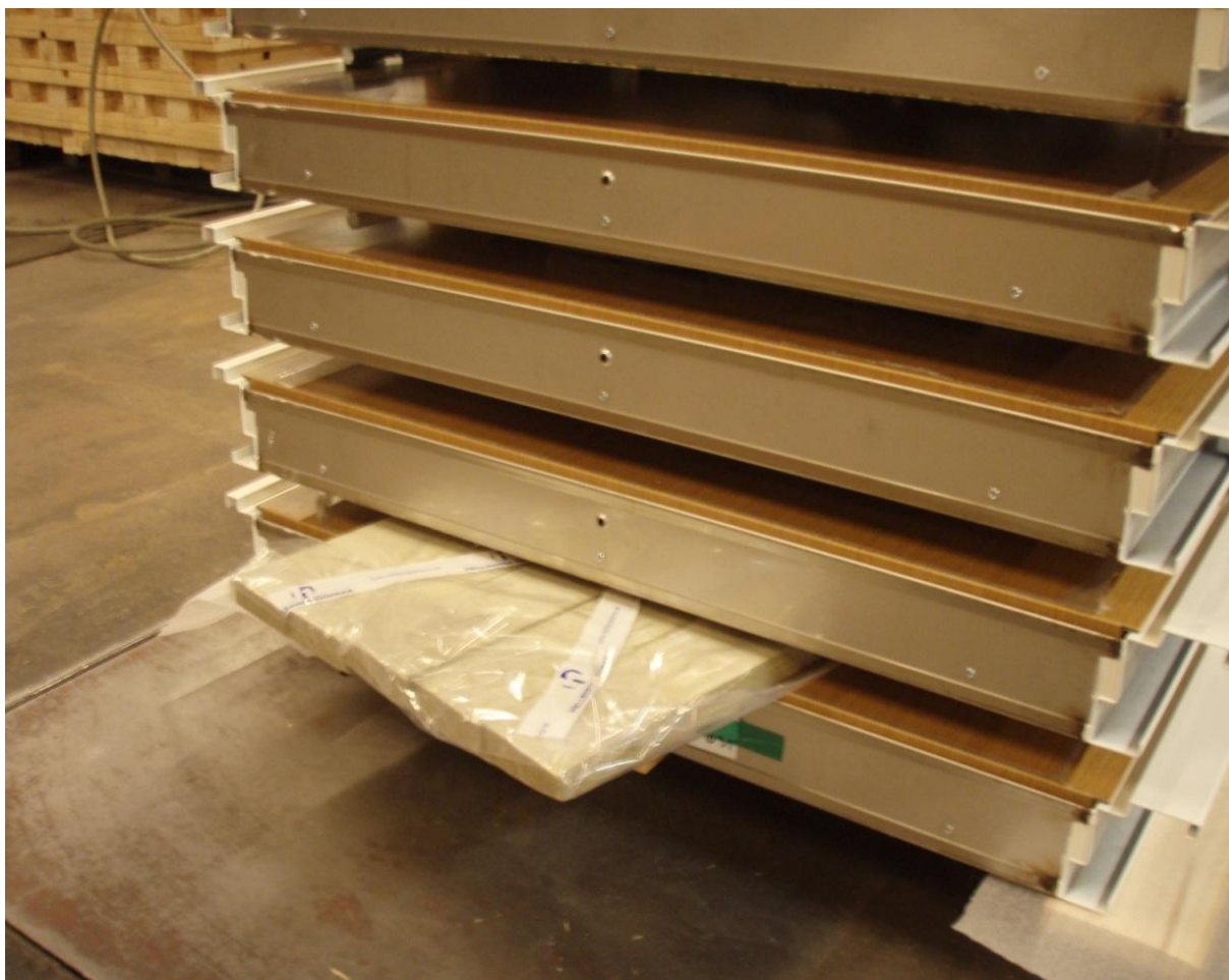
Figur 6.3 Visar hur isoleringskittet placeras mellan dörrarna på emballeringsavdelningen med det nya flödet och de nya distansarna.
