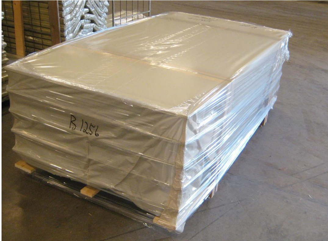
Figur 4.4 Här är dörrarna emballerade och redo att transporteras, den spikade ramen runt dörrarna lyser igenom plasten.
