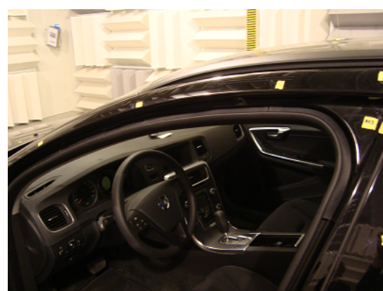
(d) Damping material added to the upper sealing
