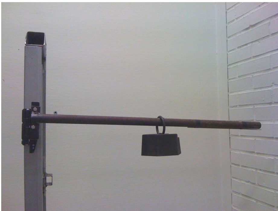
Figur 14 Stolpen belastas i provriggen
