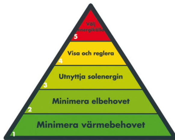
Figur 6: Kyotopyramiden beskriver en modell för projektering av energieffektiva byggnader. Pyramiden utläses nedifrån och upp där arean för varje steg motsvarar dess betydelse och vikt. Källa: Paroc AB, 2007
