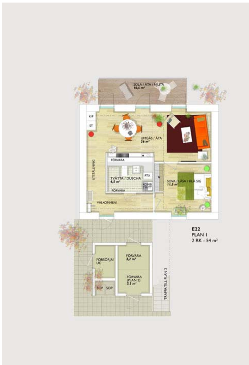
Figur 3. Planlösning över markplanet av minsta enheten E22. Uteplatsen har utgång från kök/ vardagsrum.
