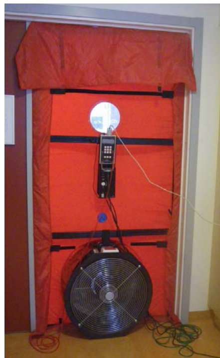
Figur 6. Monterad fläkt i dörröppning vid provtryckning (Studiebesök Niklasberg, 2010).
