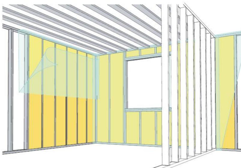
Figur 5. I en lätt konstruktion används plastfolie ofta som lufttätande skikt (Isover, 2010).
