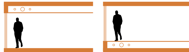
Dragning av installationer under golvet eller i undertaket.
