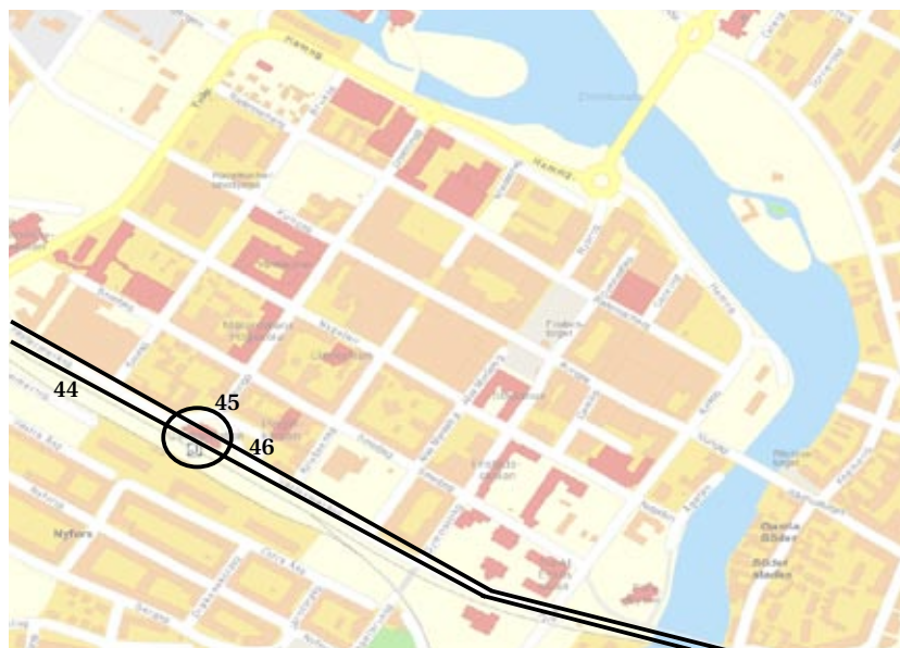
43. Dragning längs med Västermarksgatan (parallellgata till järnvägen) Cirkeln visar hållplatsen vid järnvägsstationen. Dubbla linjer betyder dubbelspår. Siffrorna refererar till respektive bild.
