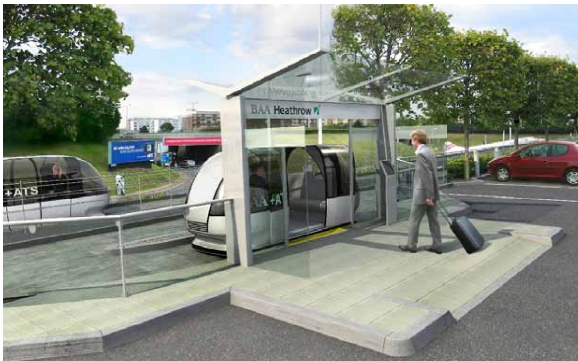
4. Förslag på spårtaxihållplats i marknivå på parkeringen vid Heathrow Spårtaxi kan av säkerhetsskäl endast gå i marknivå om banan är inhägnad. Bild: Advanced Transit Systems Ltd.
