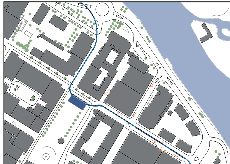
95. Schema över biltrafikens uppläggning Rademachergatan blir enkelriktad för biltrafik. Starkt orange pilar visar hur biltrafiken går. Svagt orange visar var endast viss nyttotrafik är tillåten, till exempel för inlastning till hotellet. Hastigheten är då begränsad till 10 km/h. Skala 1 : 4 000 @ A4
