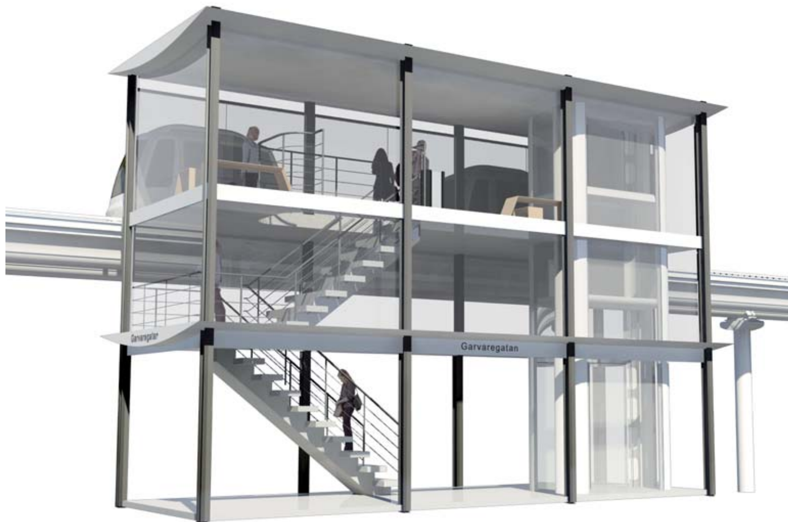
10. Exempel på typstation med tre vagnsplatser Bild: Karl-Johan Tomczak, WSP Civils
