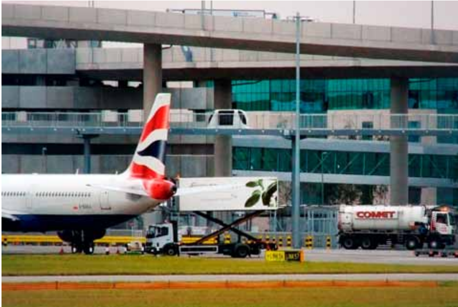
5. Upphöjd spårtaxibana på flygplatsen Heathrow utanför London Bild: Advanced Transit Systems Ltd.
