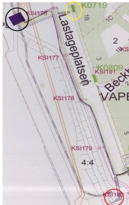
Figur 50. Områdeskarta, nätstationen finns längst upp till vänster (svart ring), frekvensomriktaren längst ner till höger (röd ring) och mätarrum finns till vänster om den gula markeringen. Större karta finns i bilaga B.
